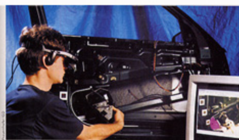
Technik der offenen Tür: Der Monteur erhält über die Brille eine Bedienungsanleitung, wie er das Schloß in die Autotür einbauen muß.
