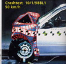
Augmented Reality beweist: Das Auto wird beim Crash genau so zerknautscht, wie es der Rechner simuliert hat.
